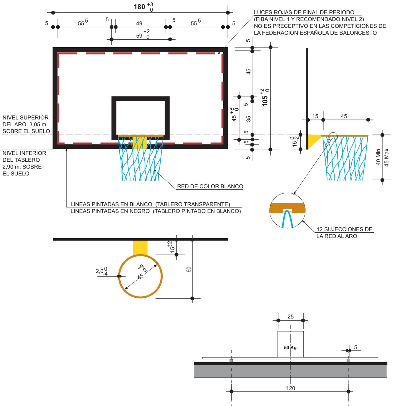
**ESQUEMA DEL ENSAYO DE RIGIDEZ DEL
